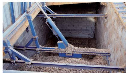
**La section technique de qualification automatique-électromécanicien** a été impliquée dans le projet de chaudière à bois. Elle s'occupe au quotidien de la maintenance de différentes parties de la chaudière. Elle a conçu un dispositif d'ouverture hydraulique automatisée pour la trappe du silo de stockage des plaquettes de bois en 2011.
